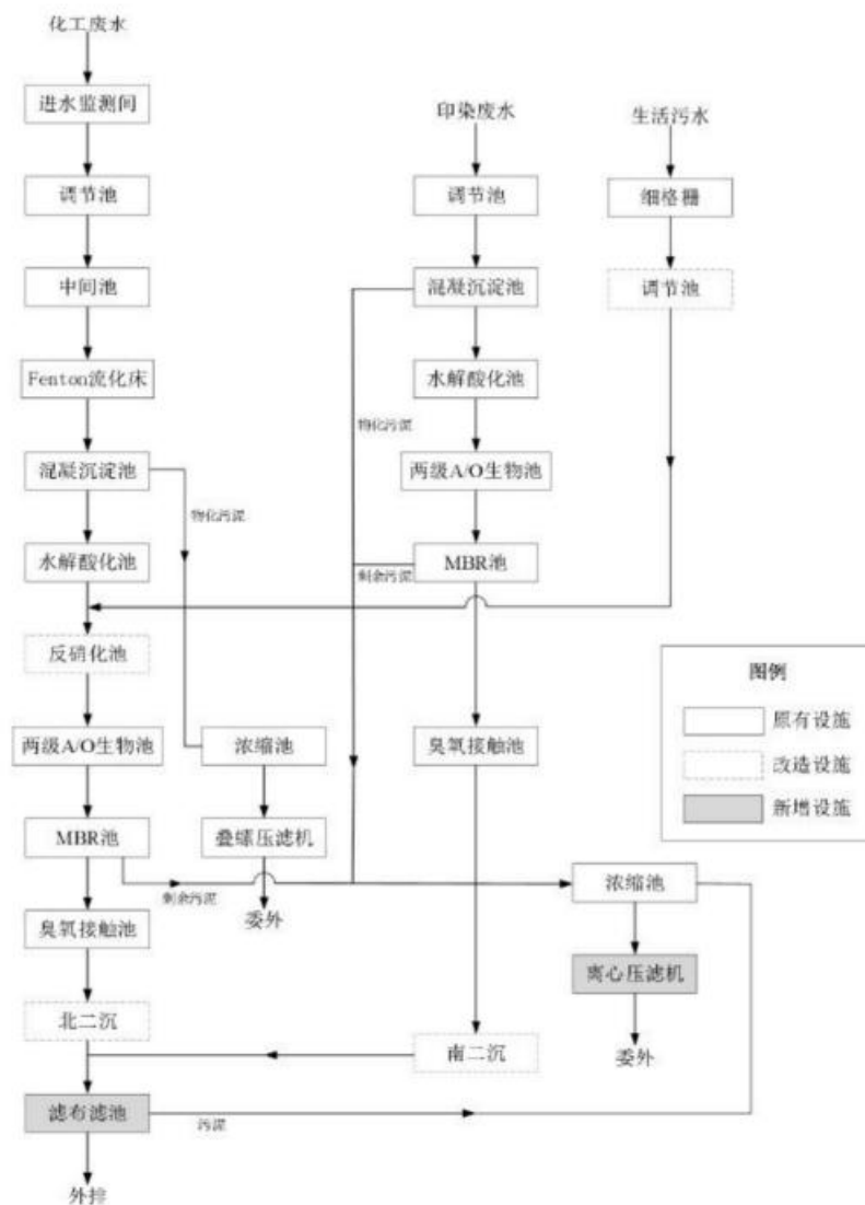
图 4-1 依托污水厂污水处理工艺流程
