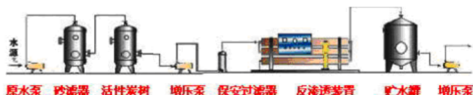
图 3.1-3 反渗透工艺纯水制备流程图
