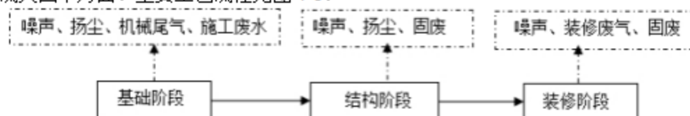
图 4-1 施工期工艺流程图
