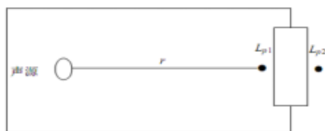
图4-3 室内声源等效为室外声源图例
