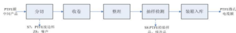
图 2-8 PTFE 微孔电缆膜工艺流程图
